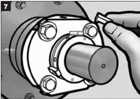
Togliere i 3 fermagli di centraggio; conservare le viti e i fermagli di centraggio per reinstallare la tenuta o per possibili regolazioni future della girante.
