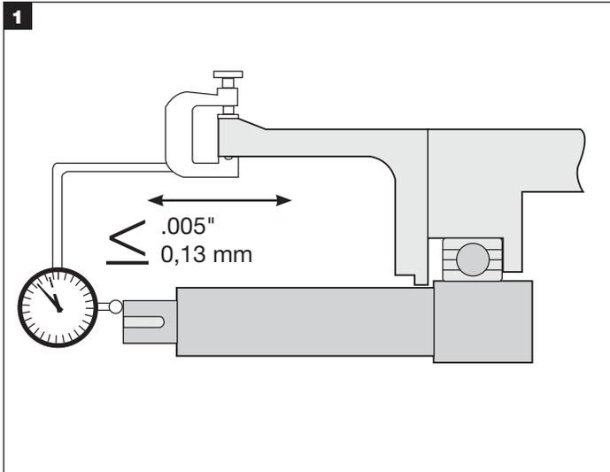
Se possibile, posizionare un comparatore alla fine dell'albero o su un gradino dell'albero per misurarne la corsa. Spingere e tirare l'albero alternativamente in direzione assiale. Se i cuscinetti sono in buone condizioni, questo gioco non deve superare gli 0,13 mm (0,005").
