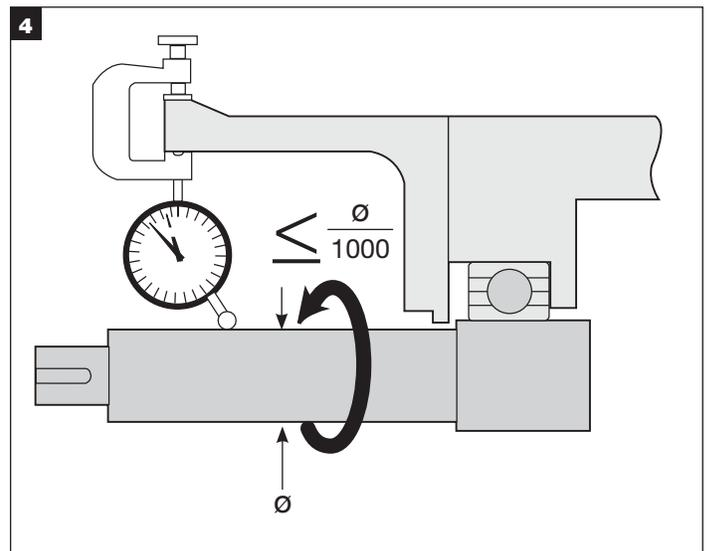
Usare un comparatore per misurare l'eccentricità dell'albero dove la tenuta deve essere installata. La lettura non deve superare i 0,005 mm (0,005") TIR per millimetro di diametro dell'albero.
