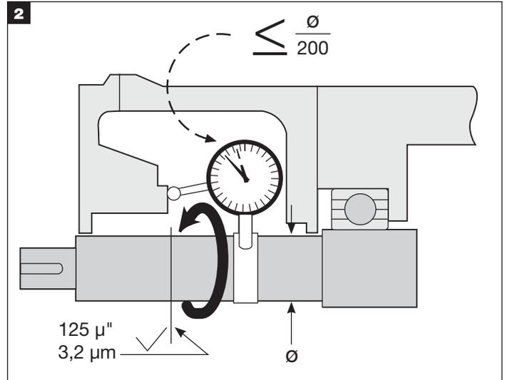
Se possibile, collegare all'albero la base di un comparatore, far ruotare lentamente l'albero ed il comparatore, leggendo contemporaneamente l'eccentricità della faccia della cassa stoppa. Il disallineamento della cassa stoppa relativo all'albero non deve superare gli 0,005 mm (0,005") TIR per millimetro di diametro dell'albero.
